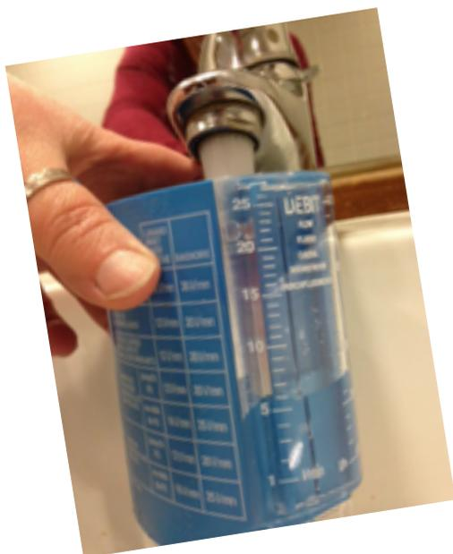
Le bol débitmètre vous permet de mesurer en quelques secondes le débit de vos robinets d'eau, et ce jusqu'à 25L/min.
