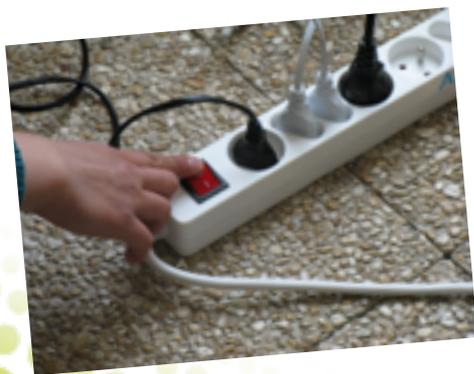
La multiprise à interrupteur permet d'éteindre les appareils branchés en même temps et d'économiser l'énergie due à la consommation des veilles lorsque les appareils restent sous tension. Branchez la multiprise sur la prise murale, puis branchez vos appareils sur la multiprise. Lorsque vous voulez les éteindre, appuyez simplement sur l'interrupteur de la multiprise. Cela convient particulièrement aux installations multimédia par exemple.
