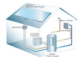
Des panneaux solaires thermiques permettent de chauffer l'eau chaude sanitaire et une partie de celle de votre réseau de chauffage.
