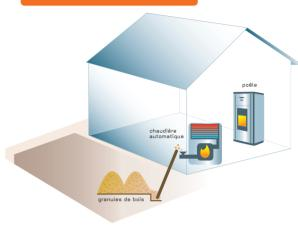
Chaudière automatique ou poêle (à granulés, plaquettes ou bois fragmenté). Le matériel doit avoir un rendement minimal (poêle : 80% et chaudière automatique : 85%) ou être labellisé Flamme Verte 5\*. Subvention de GPSO : forfait de 500€ pour un poêle et 900€ pour une chaudière.
