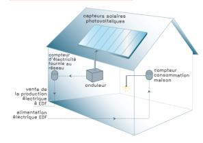
Des panneaux solaires photovoltaïques produisent de l'électricité qui peut être revendue. Le matériel doit être certifié EN61215 ou NF EN61646.
