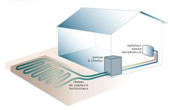
Ce système électrique permet de transférer les calories du sol pour les restituer à l'intérieur de l'habitation. Le matériel doit avoir un coefficient de performance (COP) supérieur ou égal à 3,4 et ne doit pas utiliser de fluide frigorigène à gaz à effet de serre.
