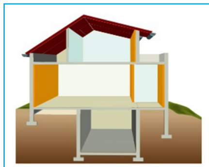
Isolation par l'intérieur: rupture de l'isolant (en orange) au niveau des planchers intermédiaires et des cloisons intérieures (source: ©ADEME)
