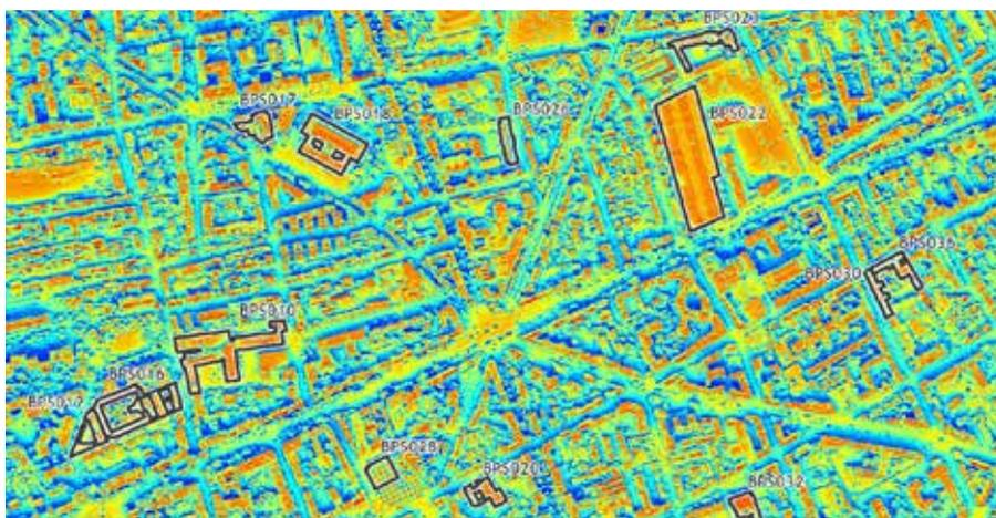
Potentiel solaire en toiture, exemple sur le périmètre de la ville de Boulogne-Billancourt (bâtiments ayant une toiture de plus de 800 m<sup>2</sup>).
